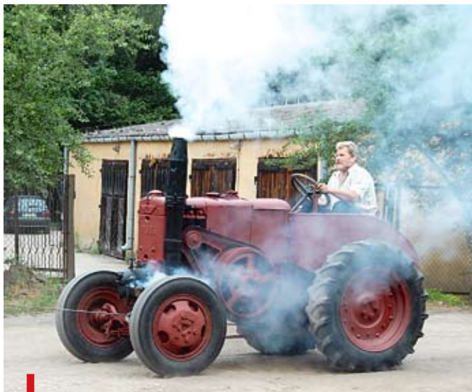
Po podgrzaniu palnikiem gazowym odbyło się holowanie i wreszcie silnik ursusa zaskoczył. Za kierownicą Tomasz Dzikowski
