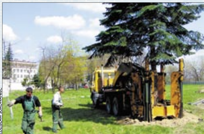
Maszyna do przesadzania drzew umieszcza wyrwany świerk w nowym miejscu
